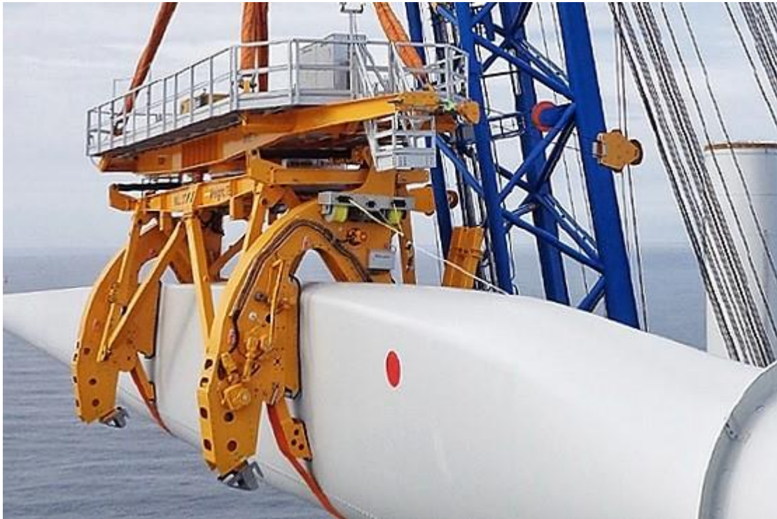
Eksempel på avanceret løfteudstyr: Løfteåg til vindmøllevinger fra Eltronic Wind Solutions
